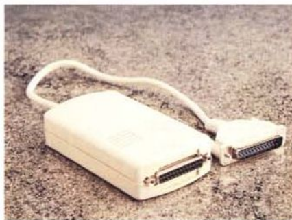
Particolare dell'interfaccia che duplica anche la porta parallela.
